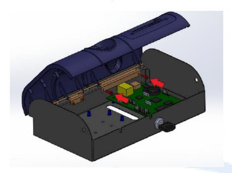
• Feche a tampa, recoloque os parafusos laterais e trave o equipamento com a chave.
