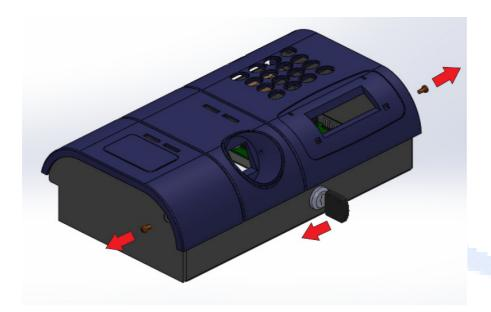
• Com o equipamento aberto remova os 2 parafusos que prendem a cantoneira da tampa do Display.
