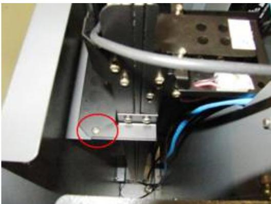
3-Retirar o parafuso que fixa a urna no suporte inferior (acesso por baixo da catraca com chave Philips curta).
