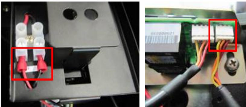
11-Retirar um cabo extensão do leitor da Urna e colocar no leitor da Tampa e conectar novamente os leitores:
