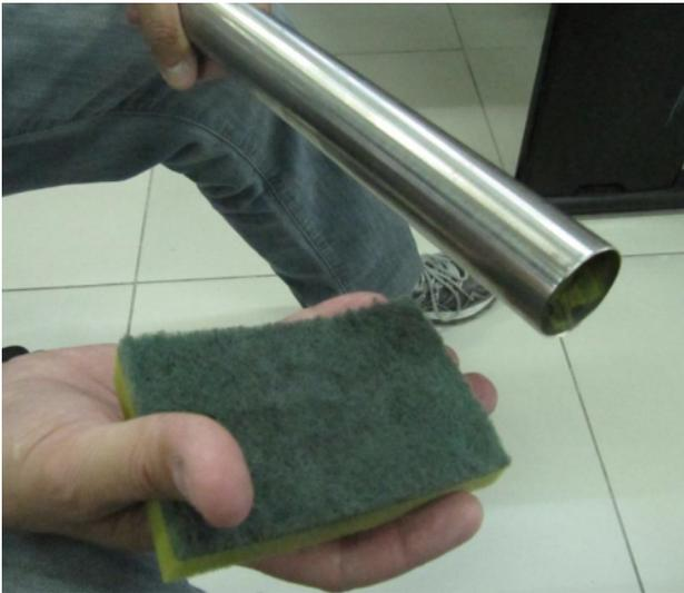
Retire o braço da catraca e com uma esponja Scotch Brite nova realize a limpeza com a parte verde da esponja.
