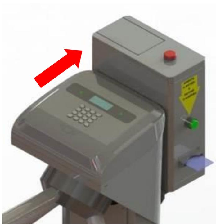
**Passo 2:** Não é necessário retirar os parafusos que fixam o mecanismo expedidor a catraca. Basta soltá-los um pouco para o deslocamento do mecanismo para trás. Para essa atividade, utilizar uma chave Allen número 07:
