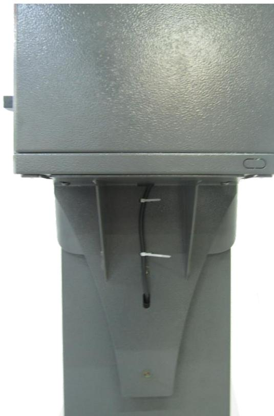
**Passo 9:** Alinhar o mecanismo expeditor de cartões na catraca sobre o suporte e colocar os 4 parafusos necessários para a perfeita fixação. Para essa atividade, utilizar uma chave Allen número 07:
