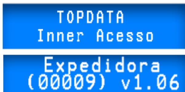
Em seguida, a *Catraca Fit 3 Expedidora* entrará automaticamente no modo de configuração local. O display mostrará a seguinte mensagem:
