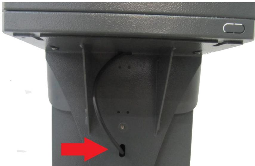
**Passo 7:** Conectar o cabo ao conector equivalente existente dentro do pedestal da catraca Fit 3 e que realizará a conexão da placa PCI INNER ACESSO ao mecanismo expedidor de cartões:
