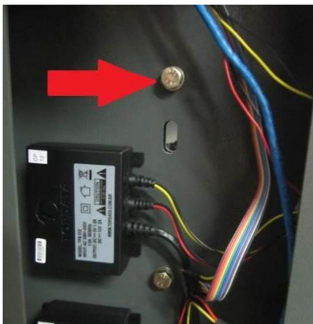
**Passo 4:** Com uma chave tamanho 13, apertar firmemente os dois parafusos do suporte junto à catraca.
