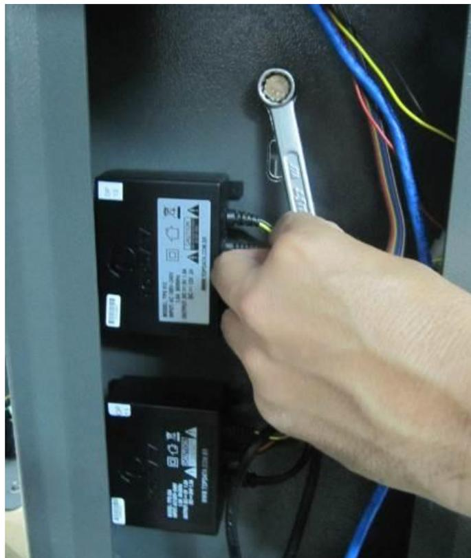
**Passo 5:** Pronto, o processo de fixação do suporte ao pedestal da catraca foi finalizado e está pronto para instalação do mecanismo de expedir cartões.
