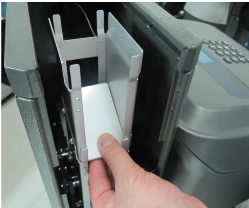
**Passo 3:** Ao término da carga dos cartões no gabinete, colocar a peça que acompanha o produto conforme posição indicada. Essa peça é importante para manter os cartões alinhados dentro do gabinete.
