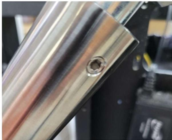
**Passo 2** - Remova os 3 parafusos que prendem a capa do mecanismo utilizando uma chave Philips ou Allen conforme o modelo da cabeça do parafuso.
