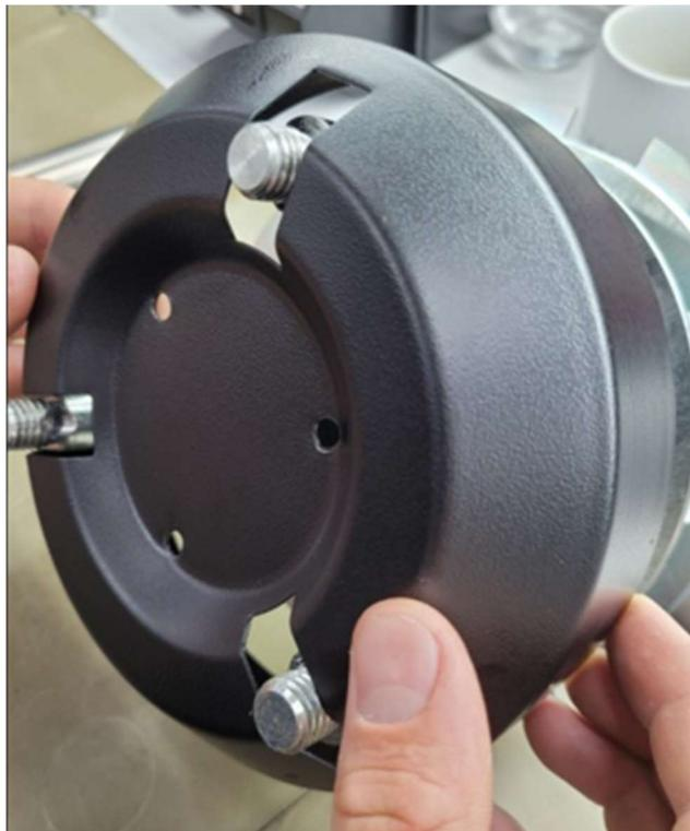
Passo 3 - Com uma Chave de Boca nº13 ou estrela solte a porca trava e gire um pouco o parafuso utilizando uma Chave Allen 6mm. Verifique na ponta do pino do braço se não tem um grande jogo, se tiver gire um pouco mais para ficar com um jogo mínimo. Depois de regulado o parafuso aperte a porca para trava o parafuso.
